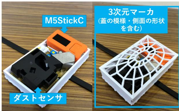
図 4. Dustoon コントローラに装着したセンサ
