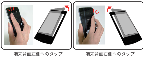
図 7. 背面タップの衝撃によるスマートフォンの振動の概観。背面タップの位置によって振動方向が異なる。
