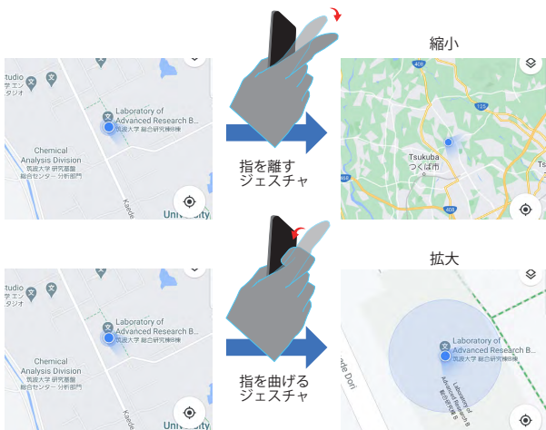
図 2. 地図アプリケーションにおける操作に入力法 1 を応用した例。指を曲げるジェスチャまたは指を離すジェスチャに応じて地図を拡大または縮小することができる。
