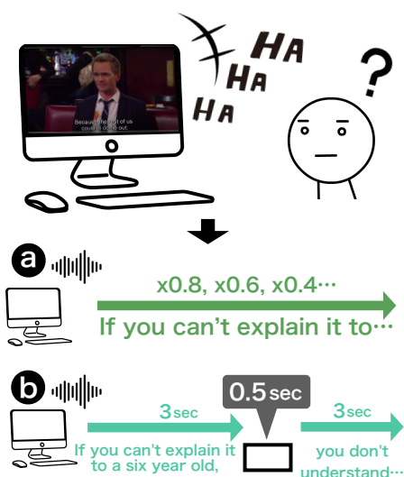
図 1. システムの概略図. a) 動画の再生速度を遅くする手法. b) 動画の再生途中に一時停止時間を設ける手法.
