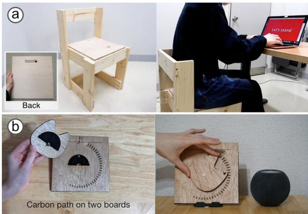
図 6. (a) インタラクティブチェア。座面の裏に炭配線が作成されている。長時間の静的な着座を検出すると、ユーザに通知を行い姿勢の変更を促す。(b) 木製の音量コントローラ。ダイヤルを回すことでスマートスピーカの音量を調節できる。
