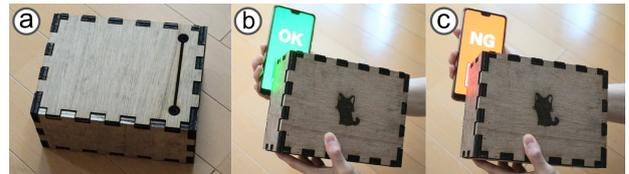
図 5. 衝撃履歴検出ボックス. (a) 箱の底に炭配線が作成されている. 配線の破損はスマートフォンアプリで容易に検知できる. (b) 炭配線を介したタッチ入力検出される. (c) 衝撃を加えたところ, 炭配線が破損し衝撃履歴が検出された.
