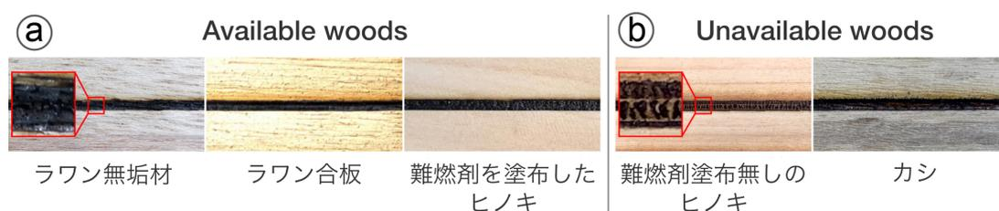
図 3. 木材表面に生成した炭配線の例。(a) 本手法が適用可能な木材。ラワンや難燃剤を塗布したヒノキは導電性を持つ炭配線を生成できる。(b) 本手法に不向きな木材。炭の粒同士に間隔があり配線が十分に黒くならず、導電性が低い。
