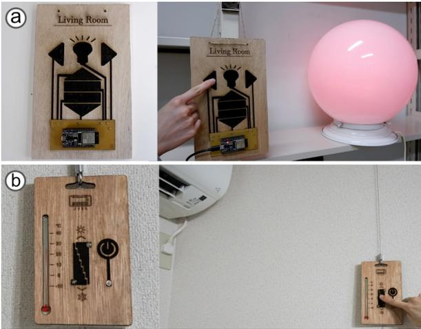
図 4. (a) 調光ボード (ボード全体のサイズ: 255 mm×155 mm). 矢印型のスイッチをタッチして光の色を制御できる. (b) エアコンの制御ボード (ボード全体のサイズ: 167 mm×103 mm). スライダーに触れることで温度調節が可能である.
