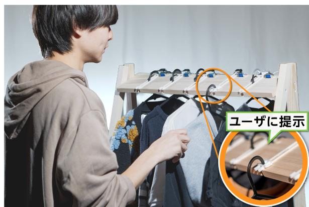
図1. ハンガーラック外観。ハンガーが手前にスライドし、ユーザに提示される。
