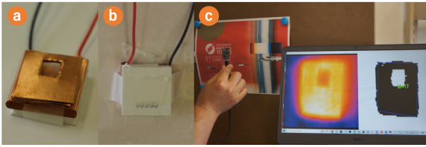
図 3. (a) 伝導型熱マーカの外觀. (b) 紙に貼り付けたマーカの裏側. (c) ポスターに貼り付けたマーカの読み取り.
