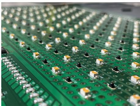
図 1. センサチップが格子状に配置された基板
