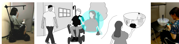
図 1. 遠隔車椅子システム: (左) 遠隔介助者を見る車椅子使用者, (中央) コンセプト, (右) 車椅子使用者とその周囲を観察する遠隔介助者.
