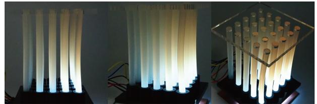
図 3. マトリクス型ディスプレイの表現例 2. 側面から見た図(左). 斜めから見た図(中央). 上から見た図(右). (1/125sec, F5, ISO6400)
