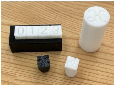
図 4. ABS で作成した型の例
