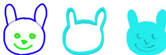
図1 デザイン図と3次元モデル。(左)提案システムでデザインした画像、(中央)出力したフレーム型、(右)内側を装飾するための型。
