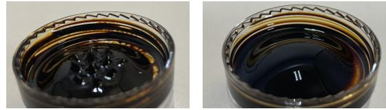
図 4: 磁性流体の形状変化例。左: 磁性流体のみ, 右: オイルを混合した磁性流体。
