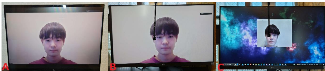
図 2. A: 上部の内蔵ウェブカメラ, B: 右耳近辺に設置する小型ウェブカメラ, C: 提案システム (小型ウェブカメラ使用) の比較
