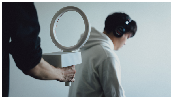
図 1. WhisperCast でヘッドフォン装着者に通知を行う様子。本体には磁気を発するコイルとアンプを配している。
