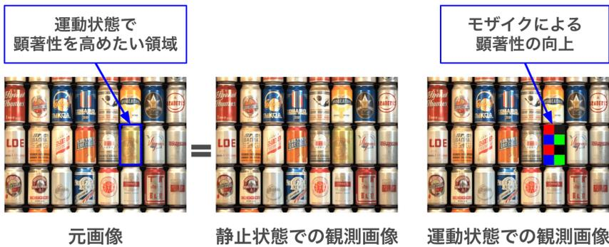
図 2. 顕著性を高めたい領域に対してモザイク手法を適応し、運動状態でモザイクが観測されるようにする
