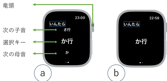
図 2. 本手法のレイアウト. a: スクリーンに 3 つのキー（選択キー、次の母音、および次の子音）にて構成されるレイアウト. b: スクリーンに 1 つのキー（選択キー）にて構成されるレイアウト。
