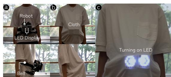
図 1. 提案する腹部装着型ウェアラブルロボットとその装着方法
