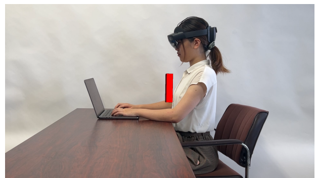
図 2. MR オブジェクトの配置のイメージ。赤い部分が仮想物体であり、ユーザはこれと自分の胸板が平行になるようにする。
