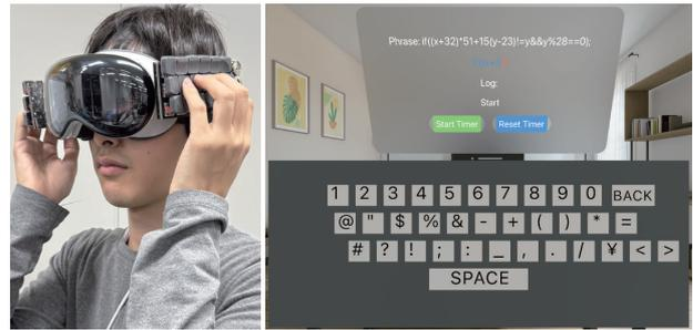
図 1. HMK を装着した様子 (左) とアプリケーション例 (右)。仮想キーボード (数字・記号) と HMK (アルファベット) を組み合わせた入力が行える。
