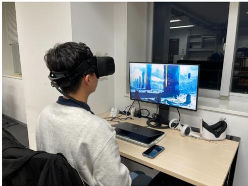
図 3. 実験の様子。HMD を装着した被験者に順に動画を見せ、視線データを取得する。
