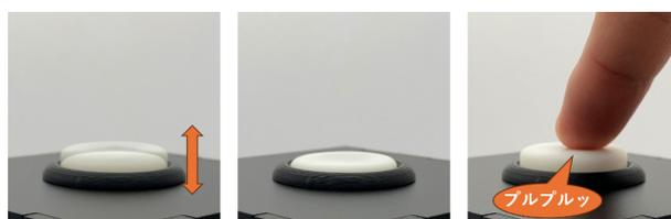
図 1. 本研究のコンセプト。ボタン型デバイスを物理的に動かして情報提示を行う。左：ボタンが上下する 中：ボタンをフラットに 右：ボタンを振動
