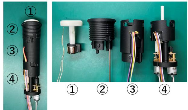
図3. ボタン型デバイスの外観。1. ボタン部 2. ストローク部 3. 押下圧部 4. 駆動部
