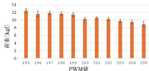
図 5. 比例電磁弁の PWM 値 (195-205) と最大荷重の関係。
