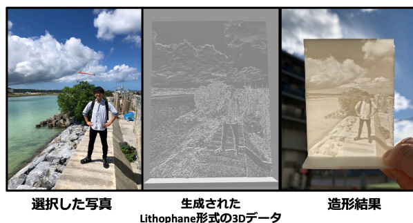
図 1. 提案システムの出力例。本手法では、送信された写真から 3D モデルを生成して Lithophane として造形する。
