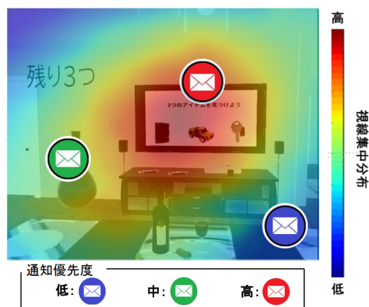
図 1. 視線の分布に従い、通知を配置する様子。優先度に応じていずれかの位置に通知が配置される
