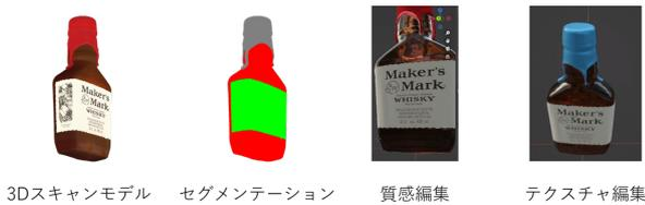
図 2. 3D スキャンモデルのセグメンテーションと編集
