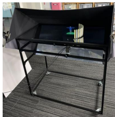
図1. テーブル型空中立体映像投影システム (AIRR テーブル)
