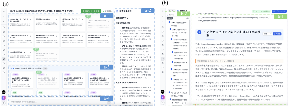
図 1. 提案システム画面. リサーチ画面 (a) では、ユーザがクエリを入力すると 10 個のタイルが生成される (a-1). タイルをクリックすると調査が開始され、完了後にはセクションのサマリ (a-2) と関連するトピックの新規タイル (a-3) が生成される. また、画面下部のチャット欄から新規トピックのタイルが生成できる (a-4). リサーチ結果表示画面 (b) では、調査結果の閲覧やセクションの再調査 (b-1)、不要なセクションの非表示 (b-2) を行うことができる.
