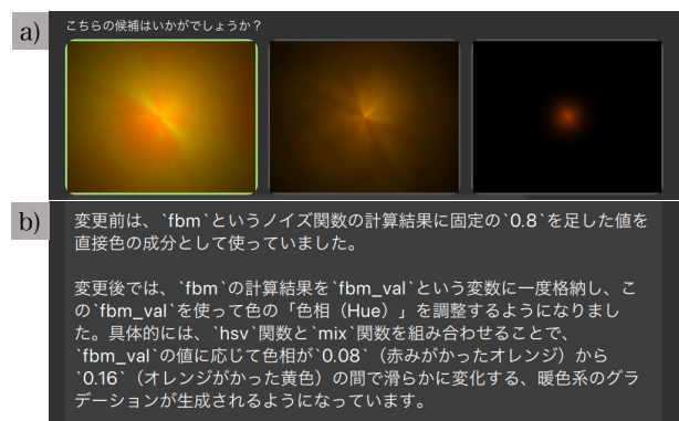
図 7. ビジュアル提案機能の利用例。(a) ビジュアル候補, (b) ユーザのコードと選択肢のコードの差分の解説。
