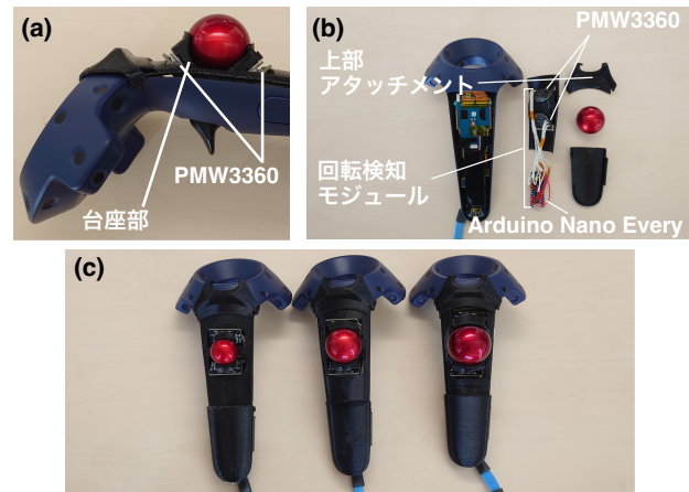
図 1. プロトタイプ実装の概観。34mm の球のプロトタイプ (a) 側面、(b) 内部構造。(c) 実装した 3 種類のプロトタイプ。球の大きさが左から 25mm, 34mm, 40mm。
