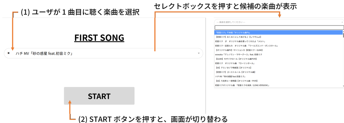
図 2. ユーザが 1 曲目に聴く楽曲を選択する画面 (セレクトボックスを押すと、選択候補の楽曲がプルダウンで表示され、その中から選ぶか、最上部の検索ボックスから楽曲名を入力して選択することができる)。
