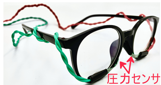
図 1. 眼鏡型デバイスと圧力センサ搭載位置
