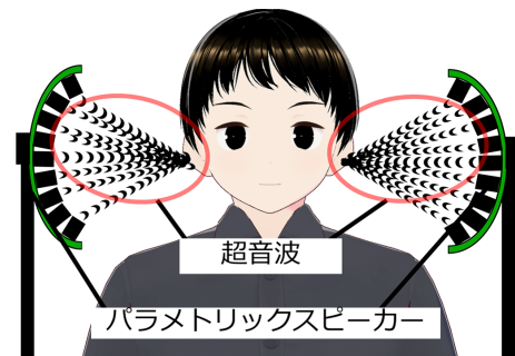
図 1. 音と触覚の同時提示システム ASSADEP.
