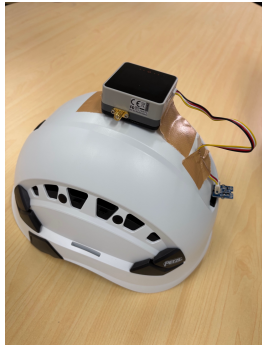
図 2. ヘルメットにマイコンと UV センサを装着. これを被った人物の UV 曝露量を計測し、AWS に送信する。
