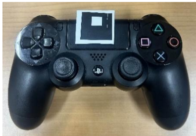
図 2. AR マーカーを貼付したゲームパッド
